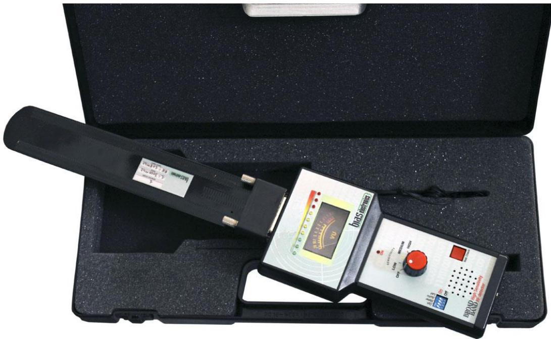
Un misuratore portatile dell'intensità di campo a radiofrequenza, detto "spazzolone"
