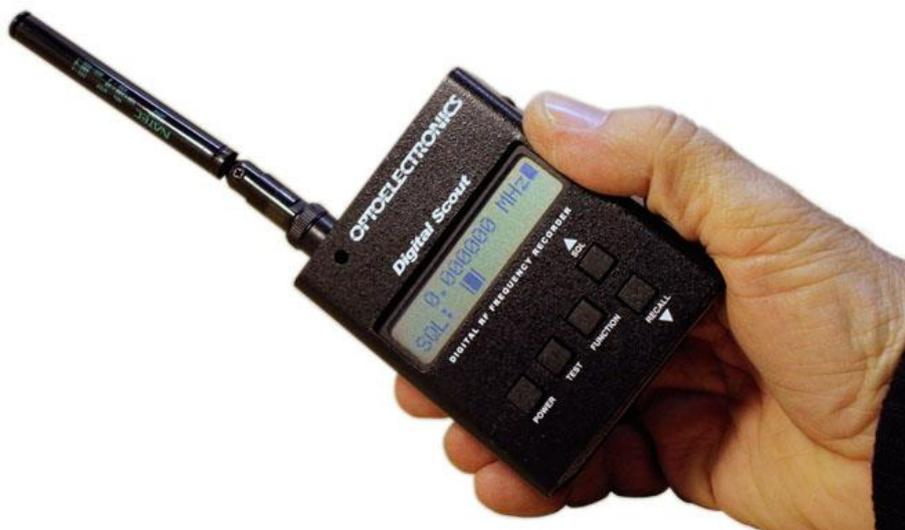
Il frequenzimetro per campi ravvicinati Optoelectronics
